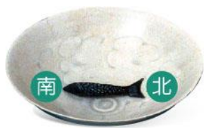
▲圖 3-16 指南魚。當時利用薄鋼片剪成魚形，製造出了指南魚，只要有一碗水，把指南魚放在水面上就能辨別方向了。
