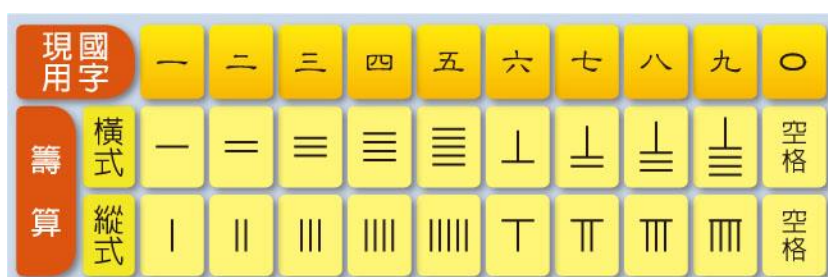
▲圖 2-19 籌算。有橫式與縱式兩種，個位用縱式，十位用橫式，百位用縱式，千位再用橫式，以此類推。以 6+7 為例，將 \perp 及 \perp 上面代表 5 的兩根籌合起來得出 10，下面的兩根籌再相加為 3，故算出 6+7=13 。
