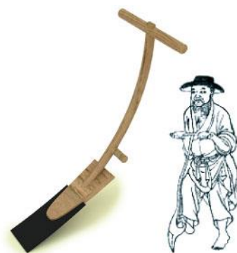
▲圖 3-15 踏犁。使用時以足踏之，達到翻土的效果。古籍稱踏犁五日，可當牛犁一日，又不若牛犁之深於土。
